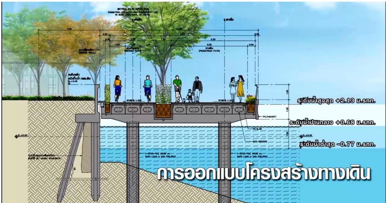
Figure 25 Coupe transversal du design de la promenade. Les trois niveaux indiqués à droite correspondent au niveau le plus haut du cours d'eau (+2,13 m par rapport au niveau moyen de la mer), niveau moyen du cours d'eau (+0,63 m) et niveau le plus bas du cours d'eau (-0,77). Source : capture d'écran sur la vidéo de présentation du projet.
