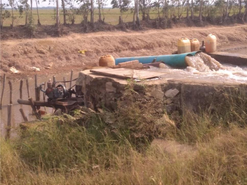
Figure 10: Premier pompage d'un canal primaire à un canal secondaire
